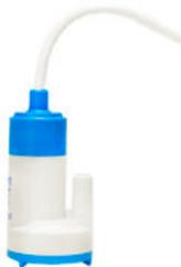
Für 12 Volt Gleichstrom, Kabel 1 m, Fördermenge max. 12 l/min, Druck 0,6 bar, Förderhöhe bis zu 6 m, Verbrauch 18-24 W, Ø 48 mm, 85 mm hoch, Trockenlauf-Dichtung, drehrichtungsunabhängig.
