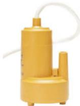
Für 12 Volt Gleichstrom Kabel 1 m, Fördermenge max. 18 l/min, Druck 1 bar, Förderhöhe bis zu 9 m, Verbrauch 25-35 W, Ø 64 mm, 100 mm hoch, Trockenlauf-Dichtung, drehrichtungsunabhängig. Die bewährte Pumpe für universellen Einsatz: Boiler, Durchlauferhitzer und Duschen.
