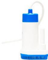
Für 12 Volt Gleichstrom, Kabel 1 m, Fördermenge max. 22 l/min, Druck 1,4 bar, Förderhöhe bis zu 13 m, Verbrauch max. 60 W, Ø 80 mm, 135 mm hoch, Trockenlauf-Dichtung mit Dauerschmierung und Entlüftung, drehrichtungsunabhängig. Ohne Rückschlagventil.
